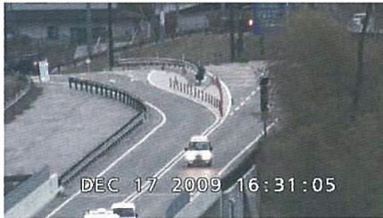
超高感度カメラ薄暮での1500m先の映像 (車がライトを点灯している程暗いが、カラー撮影が可能)
