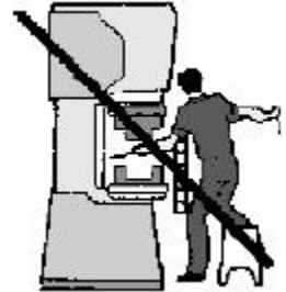
penetrazione sopra la barriera
