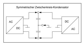
Lieferbar sind Kapazitäten von 2x  $150\mu F$  bis 2x  $1200\mu F$  bei Nennspannungen von 700V bis 1500V je Einzelkapazität.
