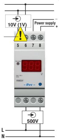
Questa etichetta è posta sul lato superiore dello strumento a coprire i morsetti di ingresso della tensione più bassa onde evitare collegamenti errati. Una volta rimossa, Revalco non risponde di danni derivanti da un collegamento non corretto.
