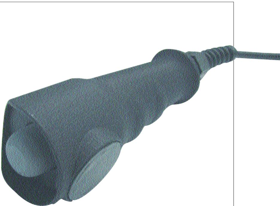
EBE Zustimmungsschalter mit Magnethalterung sind handbetätigte Befehlsgeber. Sie wurden für Arbeiten im Gefahrenbereich von Maschinen und Anlagen konzipiert. In der Betriebsart "manuell" wird die Schutzwirkung von beweglich trennenden Schutzvorrichtungen unter bestimmten Bedingungen aufgehoben. Autorisiertes Personal kann bei betätigtem Zustimmungsschalter Gefahrenräume betreten. Durch die Schaltmechanik ist beim EBE-Zustimmungsschalter kein spezielles Auswertegerät erforderlich.
