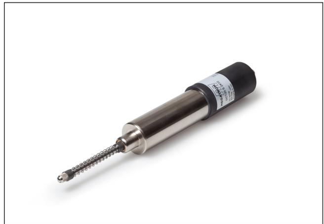
Die induktiven Wegaufnehmer der Economy-Serie EDCT sind in 4 Messbereichen zwischen 2 mm und 50 mm lieferbar. Sie haben eine eingebaute Gleichspannungselektronik, die mit 24 V versorgt wird und am Ausgang eine Spannung 0-10 V oder einen Strom 0-20 mA liefert, welche der Verschiebung der Tastspitze entspricht. Diese Wegtaster sind eine kostengünstige Lösung für die Messung und Weiterverarbeitung eines Weges oder Profiles.
