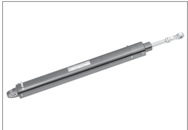
Bei den Aufnehmern der Serie WGO40 handelt es sich um ölgefüllte Typen mit hoher Dichtigkeit und einem drahtgewickelten, hochauflösenden Widerstandselement. Die Achse und das Gehäuse sind zur Befestigung mit einem Gelenkkopf versehen.
