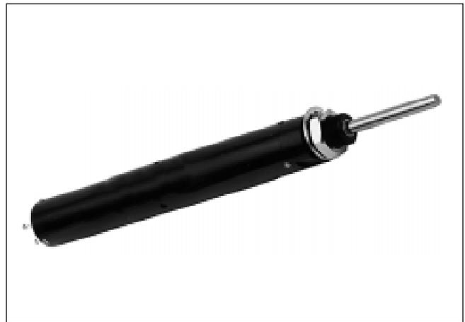
Die beiden Aufnehmerserien WGO10 und WGO20 sind ölgefüllt, d. h. der Widerstandsabgriff erfolgt in einer mit Öl gefüllten Kammer im Aufnehmer. Durch diesen Aufbau ist der Sensor wesentlich unempfindlicher gegenüber Umwelteinflüssen und eignet sich bestens zum Einsatz unter extremen Umweltbedingungen.
