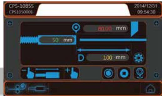
送料、擋料及後托系統的圖形操作面板
