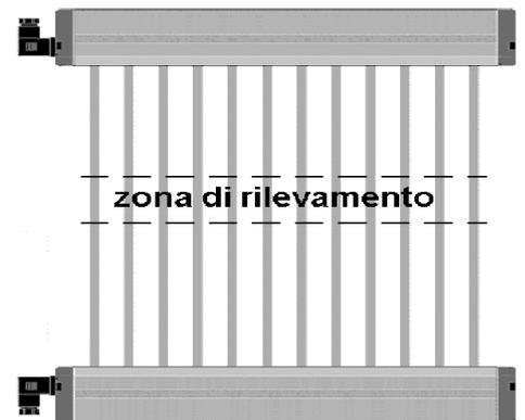
Versione 'T' con rilevamento interpolato, interasse nella zona centrale di 5 o 10mm, con interasse raggi 10 o 20mm. Ideale per il rilevamento della forma o dimensione di lastre o similari. Portata massima 0.5m o 3m per le versioni 'L'.
